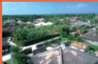
沖縄には台風がよく来ます。強い風に耐えるよう石垣でさえぎり、屋根を低くしています。
